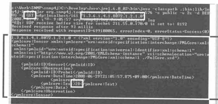
(그림 16) get, snmpV3e-response 명령어를 사용한 대용량 데이터 가져오기 예
