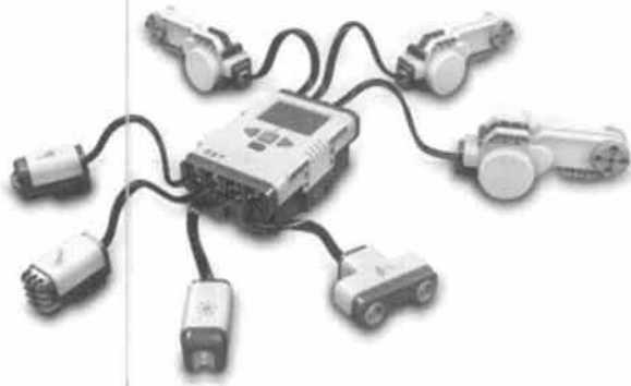
(그림 1) NXT 브릭과 연결된 3개의 모터와 4개의 센서들
