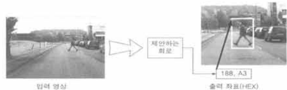
그림 9. 보행자 인식 결과 Fig. 9. Pedestrian detection result using proposed circuit
